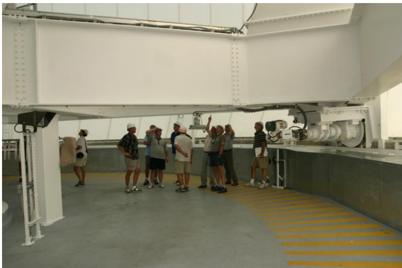
Azimutální, elektromechanický pohon radiolokátoru stanice EBR
